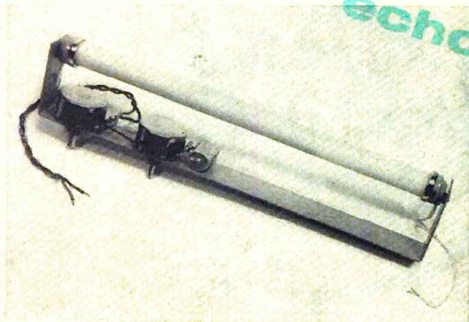
Het inwendige van de Amroh-Echo-Unit. De lange pijp bevat het mechanische vertragsings-element.
